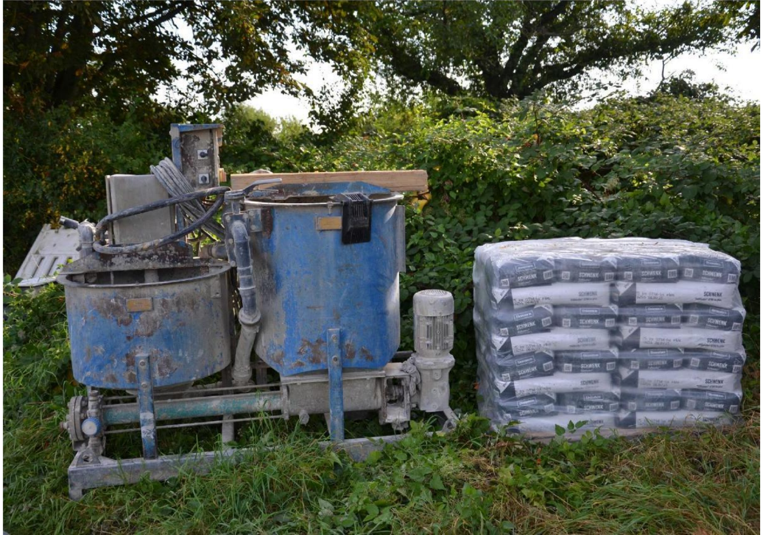
Einbringen der Sonde ins Bohrloch Chargenmischer für Verfüllbaustoff Stockstadt am Rhein, 14.09.2021
